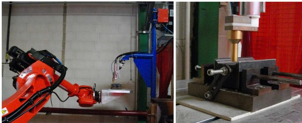
Figure 2.2. Robot de soudure avec torche PTA du CRITT MDTs
