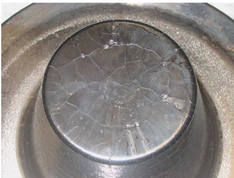
Figure 5.9. Poinçon en fin de service.
