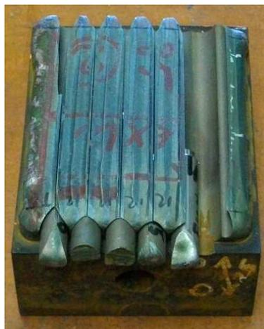
Figure 3.6. Prélèvement des éprouvettes en Stellite-6 par électroérosion.
