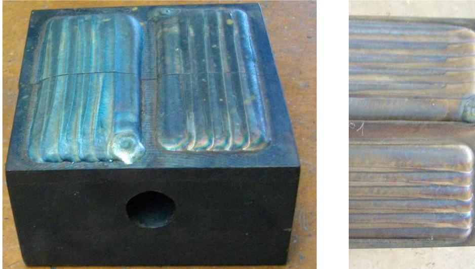
Figure 2.9. Éprouvette de rechargement et éprouvette découpée pour les analyses
