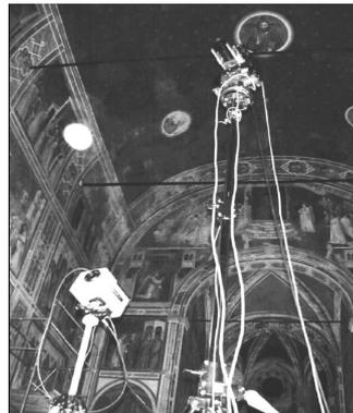
Figure I.3 : Vue de l'installation des deux appareils de mesure thermographique, avec le transept de la chapelle *Scrovegni* en arrière-plan
