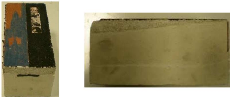
Figure IV.18 : Nouvel échantillon avec un défaut incliné en plastazote
