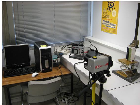
Figure IV.2 : Le premier Système d'Analyse des Matériaux Minces par Thermographie InfraRouge du Laboratoire d'Énergétique et d'Optique de la Faculté des Sciences de Reims
