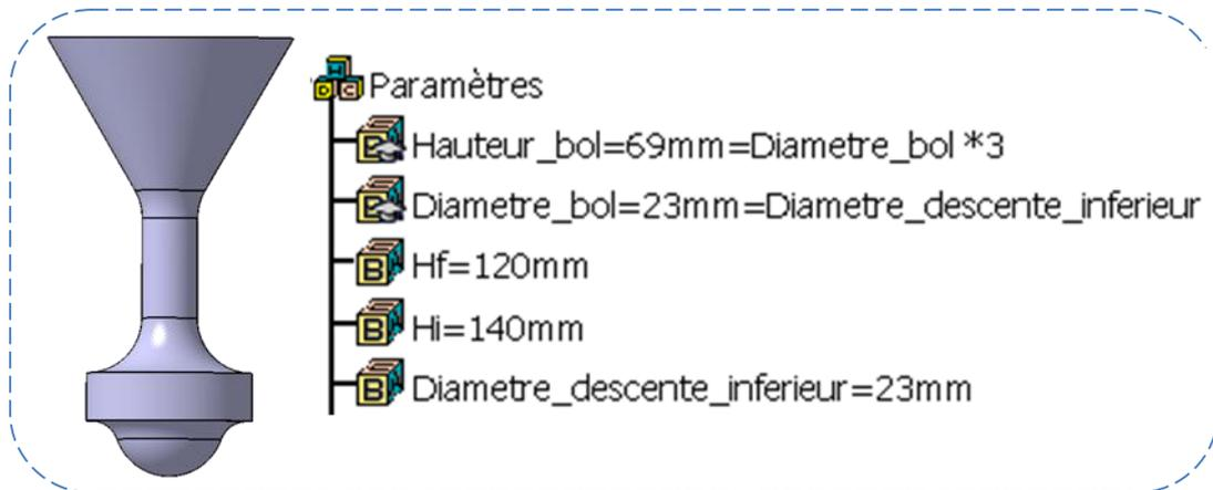
**Figure 81 - Paramètres du modèle Cao évoluant au fur et à mesure du calcul**
