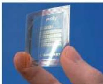
Figure I. 4 : Modèle d'une étiquette RFID flexible sur substrat polymère (PolyC)<sup>4</sup>.
