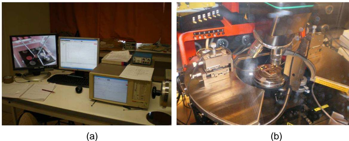
Figure III. 12 : (a) Analyseur de paramètre Keithley 4200 pour les mesures de caractéristiques courant/tension des OFETs ; (b) Transistor polarisé sous pointes en boîte à gants.
