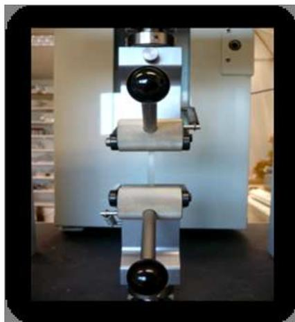
FIGURE 4.14 – Machine de traction - Système de fixation de l'éprouvette.
