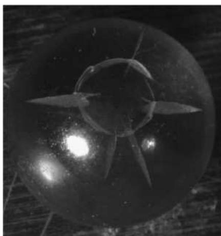
FIG. 1.32 – Fissures radiales et circonférentielles : source (Gorham *et al.*, 2003b).
