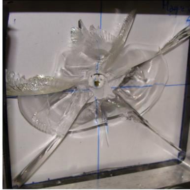
FIG. 2.4 – Post-mortem d'un essai d'impact balistique ( $V = 25 \text{ m/s}$ )
