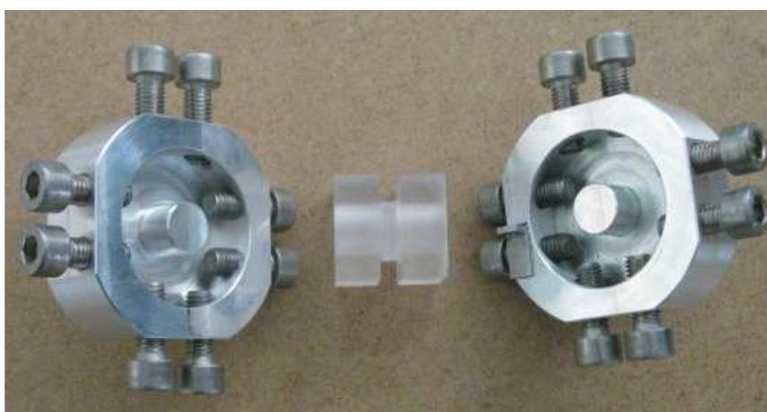
FIG. 5.19 – Montage de l'essai de torsion
