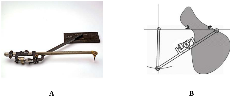
Figure IV-8 – Planimètre polaire (A) et la représentation graphique de la façon de mesurer une aire à l'aide de cet instrument (B).
