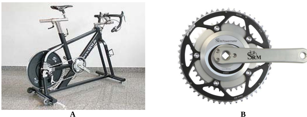
Figure III-13 – Home-trainer SRM-Basic (A) équipé d'un capteur de puissance SRM modèle Scientifique (B).
