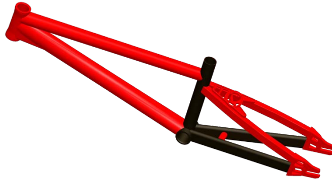
Figure VII-5 – Représentation des zones subissant les plus grandes déformations (zones sombres) dans un cadre de BMX.
