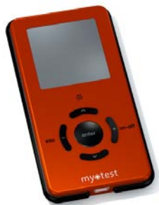
Figure III-12 – Accéléromètre 3 axes sans fil Myotest® (Myotest SA, Suisse).
