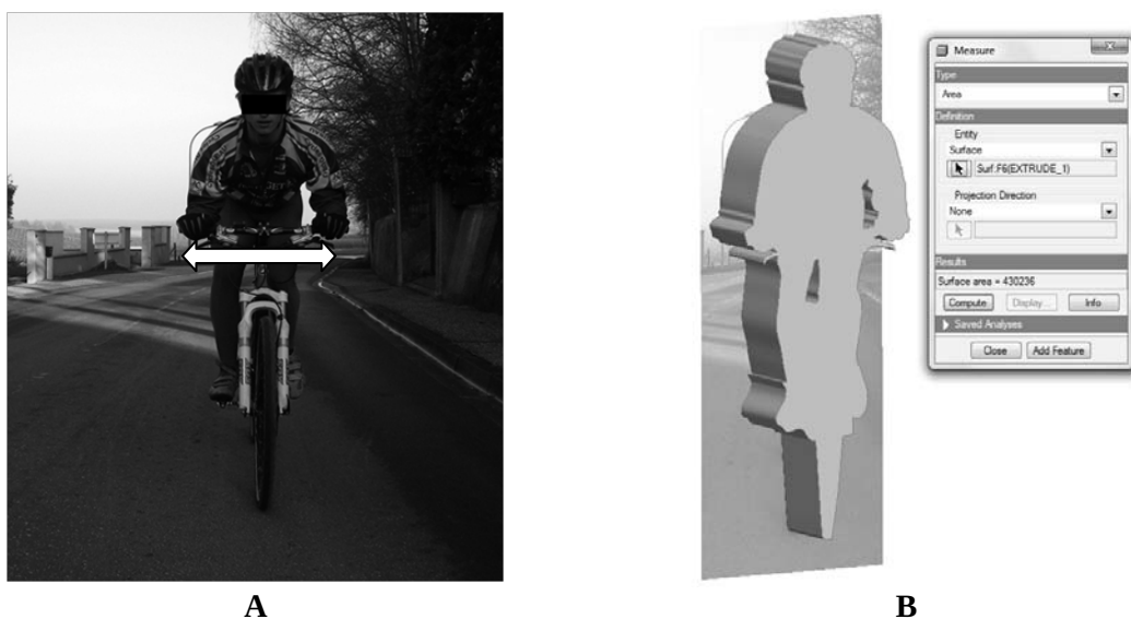
Figure IV-16 – Exemple de photographie prise en condition de terrain sans pose de zone de calibration. La référence utilisée pour remettre la photographie à l'échelle est la largeur du guidon (0,582 m) (A). L' A_p totale du sujet est ensuite mesurée à l'aide d'un logiciel de C.A.O. (B).
