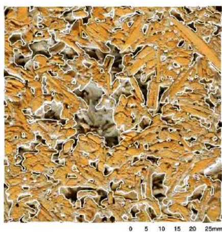
Figure 12.a : Porosité du béton de chanvre.
