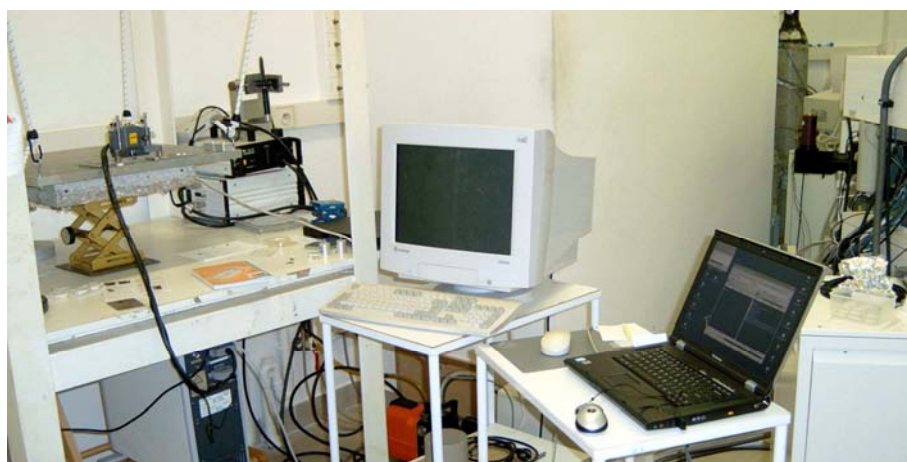
Rysunek 19 Stanowisko pomiarowe mikroskopii sił atomowych.
