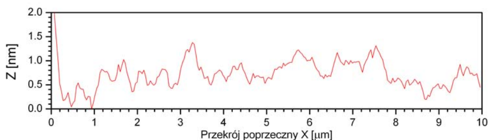
Średni przekrój poprzeczny obszaru o rozmiarach 10 x 10 \mu\text{m}
