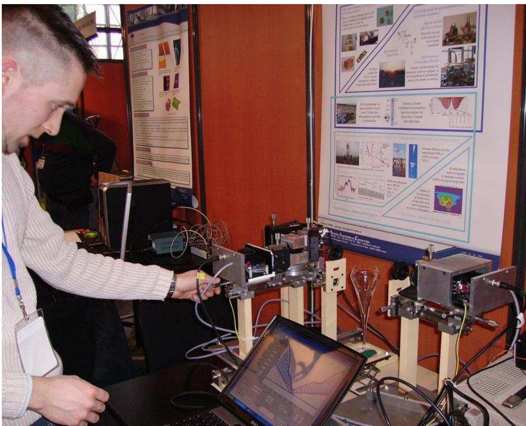
**Figure 2.19 : Démonstration du spectromètre CO<sub>2</sub> à 2,7 μm
