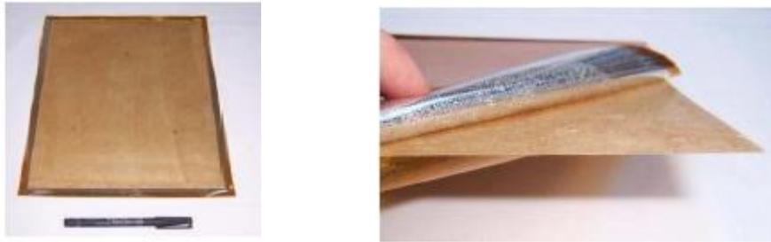
**Figure 51. Plaque composite de pré-imprégné : 16h d'irradiation et recuit 1h à 60°C.**
