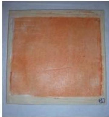
Figure 47. Tissu de verre imprégné d'un mélange SU-8 / PBE (50/50) avec 3 pcr de photo-amorceur CyFeAr.
