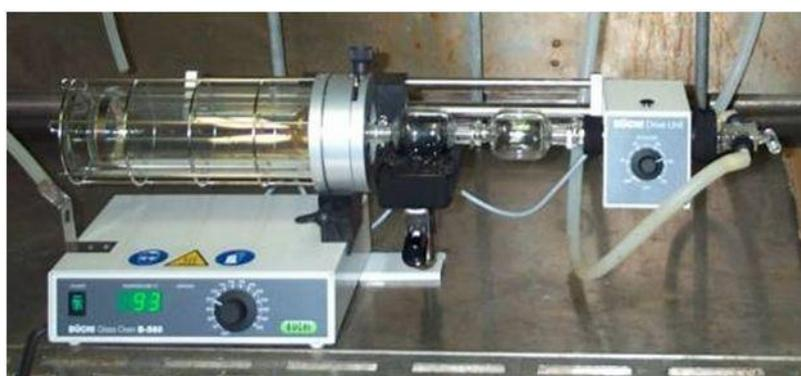
Figure 86. Système Kugelrohr (Büchi glass oven B-580).
