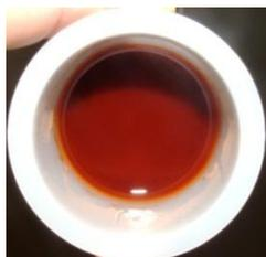
**Figure 79. Réalisation du mélange CopoP13 + 3 pcr de CyFeAr à l'aide d'un mélangeur planétaire (préchauffage de la résine à 80°C, puis 3 passages de 30s chacun dans le mélangeur).**
