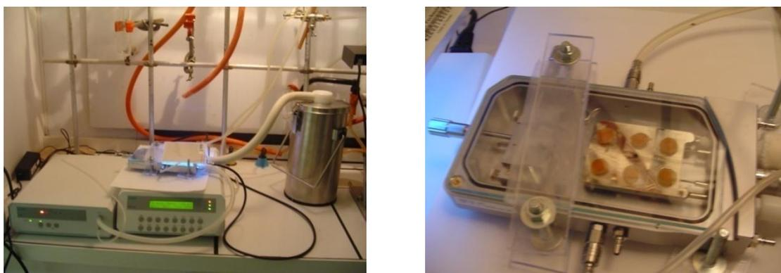
**Figure 57. Irradiation, à une température contrôlée ( $15^{\circ}\text{C} < T^{\circ}\text{C} < 23^{\circ}\text{C}$ ), de six échantillons (résine dans une coupelle en aluminium pour analyses DSC) dans une Linkam équipée d'un système de refroidissement.**
