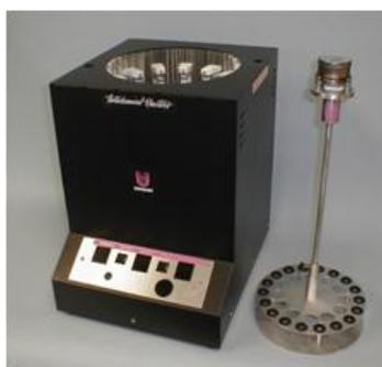
**Figure 84. Source d'irradiation utilisée : la Rayonet ( $\lambda = 350$  nm).**
