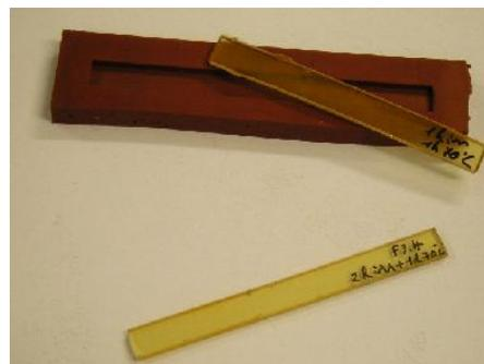
**Figure 88. Moule et barreaux utilisés pour la caractérisation des éprouvettes de résine époxyde.**
