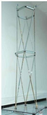
**Figure 72. Démonstrateur technologique dont la structure est réalisée avec la résine DER330 et l'amorceur thermique BPH1.**
