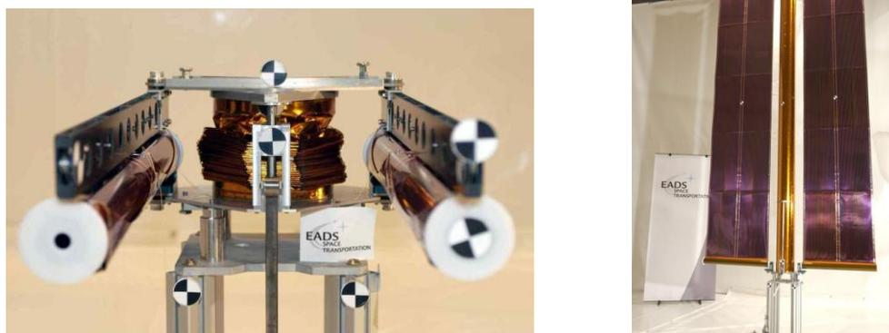
**Figure 4. Démonstrateur de panneaux solaires SDASA (*Structural Design of Advanced Solar Array*) en configuration pliée (gauche) et déployée (droite).**
