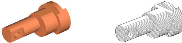
FIGURE 3.8 – *Géométrie avant et après tranchage*
