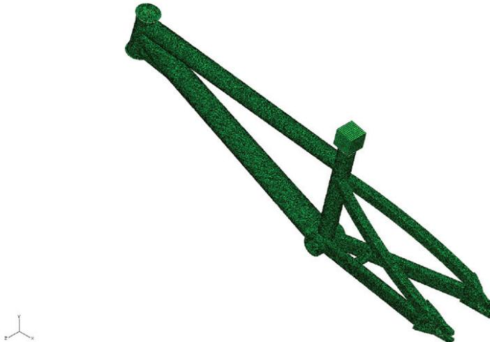
**Figure IV-19** Maillage aux éléments finis du modèle numérique 3D d'un cadre de BMX (ABAQUS™, Simulia, Dassault Systèmes, France).
