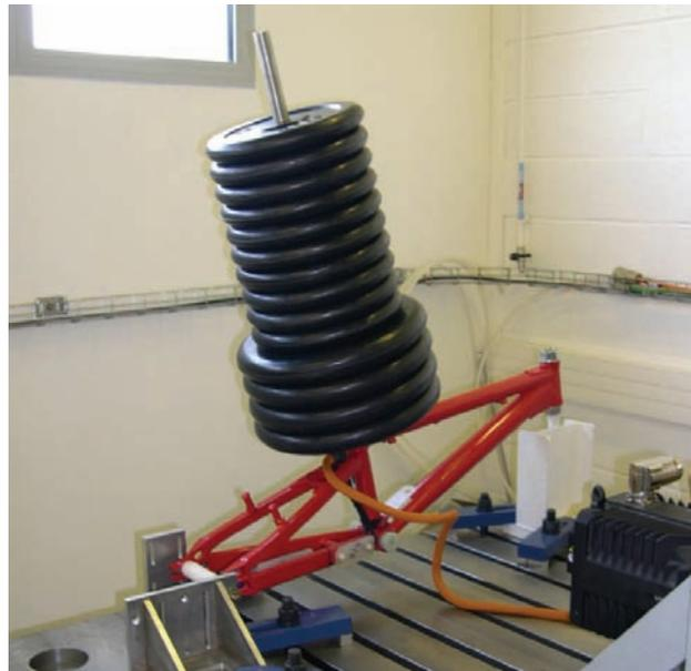
**Figure IV-17** Application d'une charge en condition statique sur le tube de selle d'un cadre de BMX.
