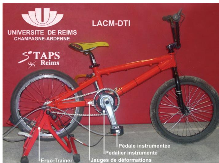
**Figure IV-34** Bicyclette de type BMX placée sur un ergo-trainer équipée d'un capteur de puissance, de deux pédales instrumentées, et d'un cadre équipé de jauges d'extensométrie.
