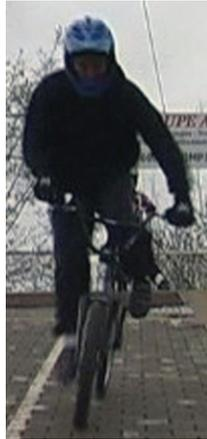
**Figure IV-9** Exemple de trame obtenue à partir d'une image vidéo au moment de l'inclinaison latérale maximale du cadre de BMX ( $\lambda$ ).
