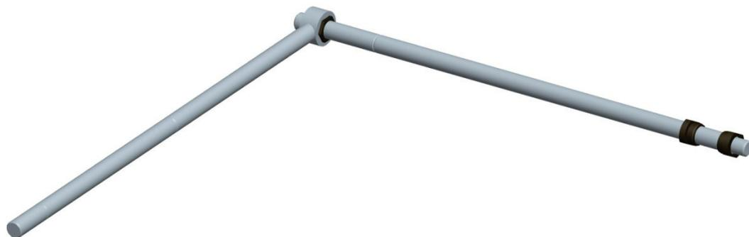
**Figure IV-28** Système composé de deux barres en Acier XC 38. Conçu pour être vissé dans l'axe de pédalier d'une bicyclette et permettant la simulation des couples appliqués par le pilote au niveau de l'axe de pédalier du cadre.
