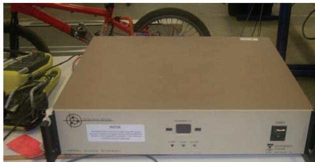
**Figure IV-37** Système d'acquisition dynamique (Model 5100A Scanner, Vishay Instruments Division, France).
