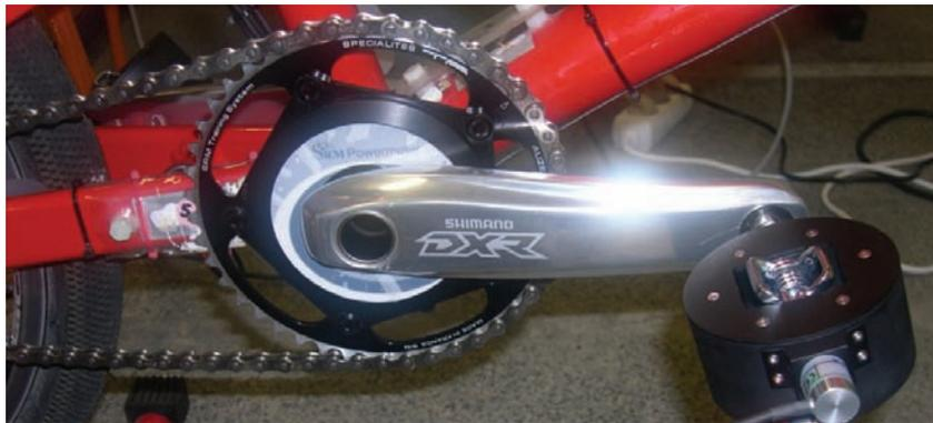
**Figure IV-36** Capteur de puissance SRM (SRM Training System BMX, Schoberer Rad Messtechnik, Allemagne).
