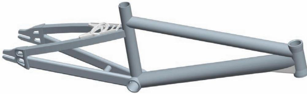
**Figure IV-16** Modèle numérique tridimensionnel (3D) d'un cadre de BMX créé à l'aide d'un logiciel de Conception Assistée par Ordinateur (C.A.O.) (Pro/ENGINEER® Wildfire™ 2.0, PTC, Etats-Unis).
