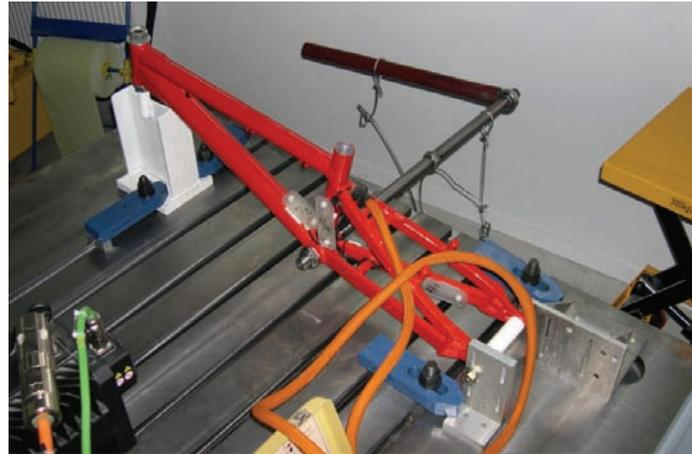
**Figure IV-29** Dispositif expérimental comprenant un cadre de BMX fixé sur un banc d'essai et un système de barres vissé dans l'axe de pédalier.
