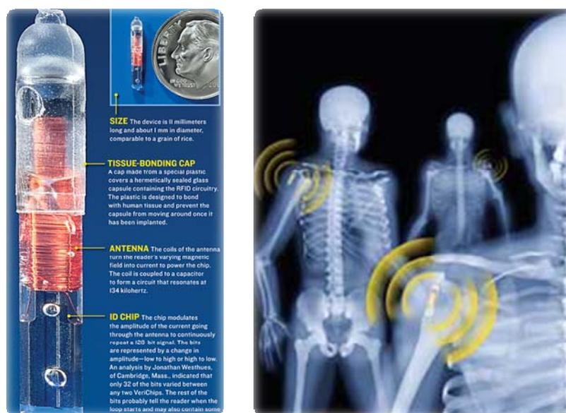
Figure 10 Le tag RFID implantable dans le corps humain par VeriChip (Foster, 2007)
