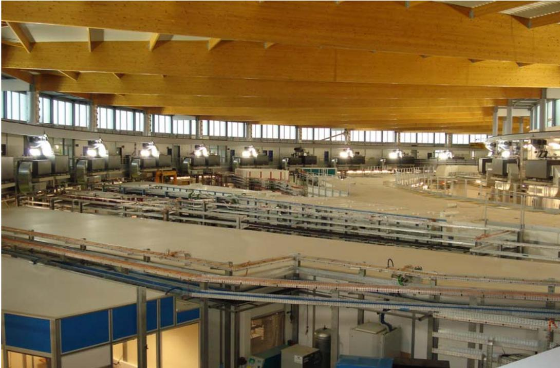
**Figure 14** : Photo montrant l'anneau de stockage et les différentes lignes de lumière.
