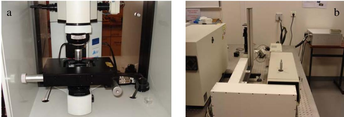
**Figure 17** : a. microscope optique de type Olympus BX40, diode laser à 785 nm.
