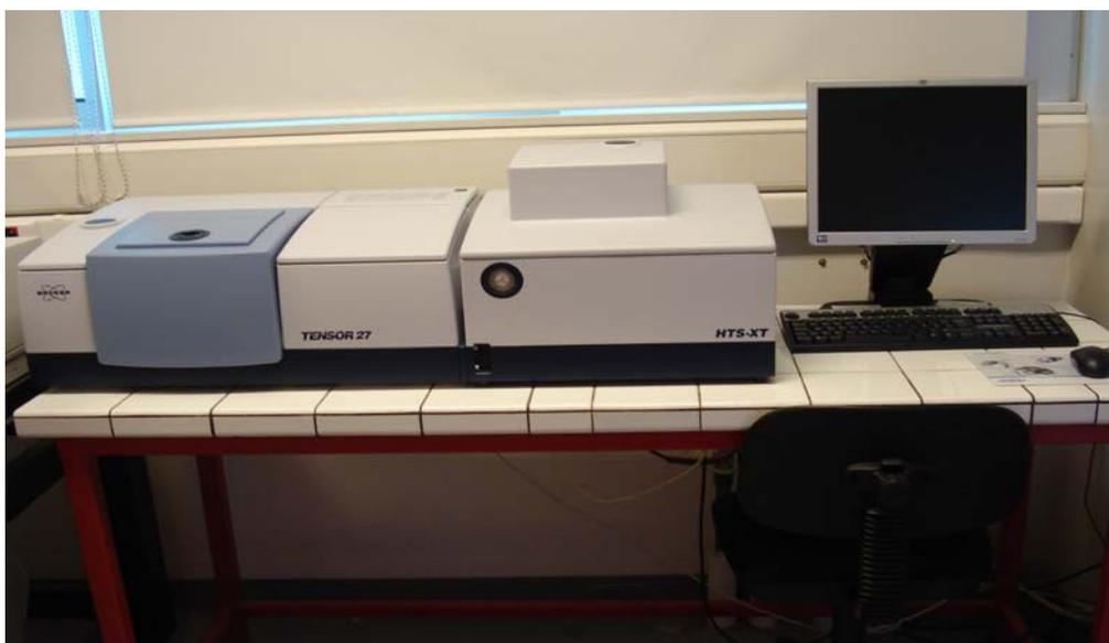
**Figure 8** : Photo représentant l'extension HTS-XT alliée au spectromètre IR-TF Tensor-27.
