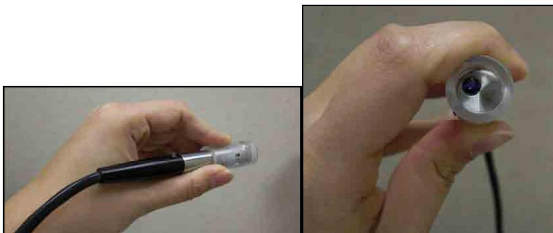
**Figure IV.01 : Sonde de mesure Raman InPhotonics**
