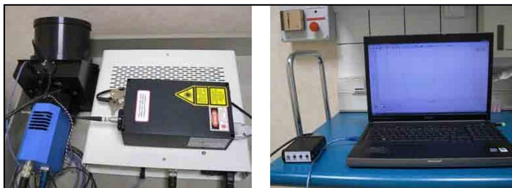
**Figure IV.02 : Système Raman portable HE**
