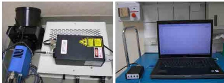
**Figure I.22 : Spectromètre Raman HE**
