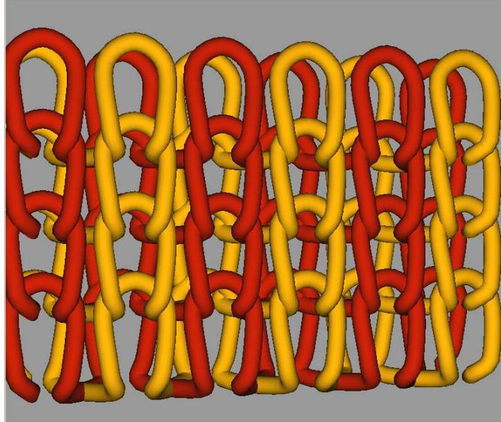
FIG. II.2.9 – Topologie générée par le liage correspondant à l'interlock 1 et 1
