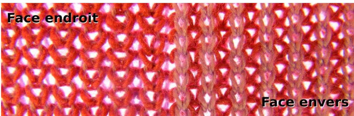
FIG. I.3.23 – Photo d'un échantillon de tricot Côte perlée
