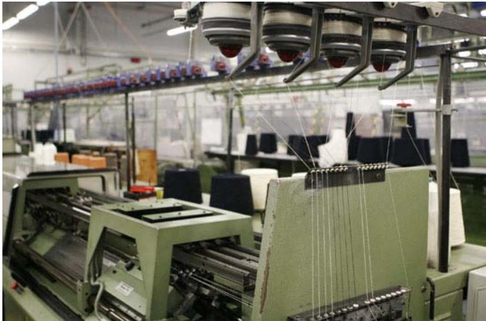
FIG. I.2.7 – Métier à tricoter rectiligne
