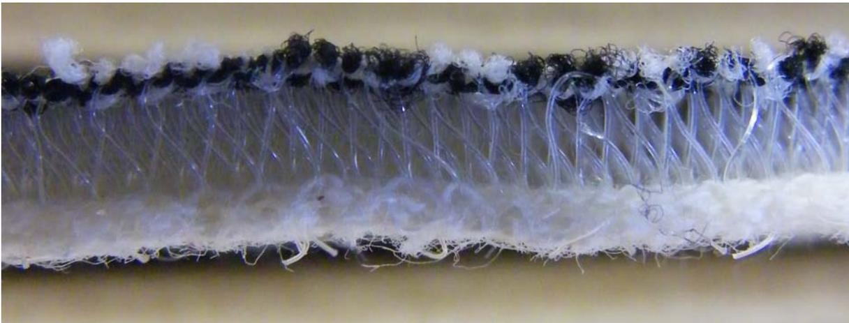
FIG. I.3.25 – Photo d'un échantillon de tricot issu du spacer 3D
