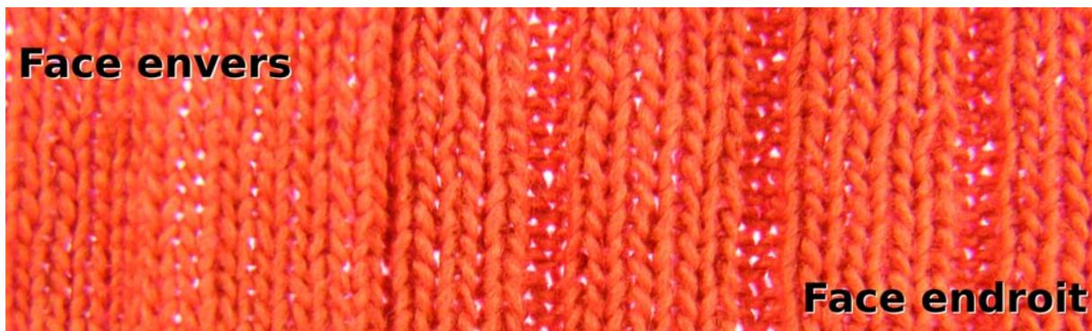
FIG. I.3.16 – Photo d'un échantillon de tricot côte Richelieu 4/6
