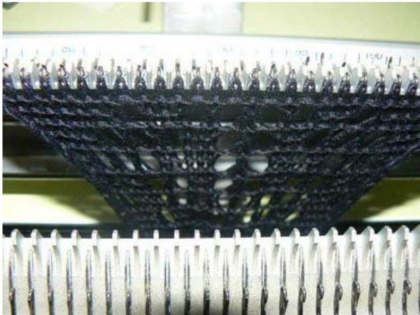
FIG. I.2.8 – Vue du dessus d'un métier à tricoter rectiligne à 2 fontures où l'on a tricoté uniquement sur la fonture arrière
