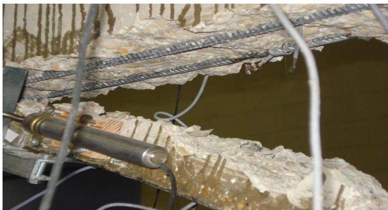
*Fig. 3.26. Rupture de la poutre renforcée par 5 couches de tissus en fibres de carbone.*
