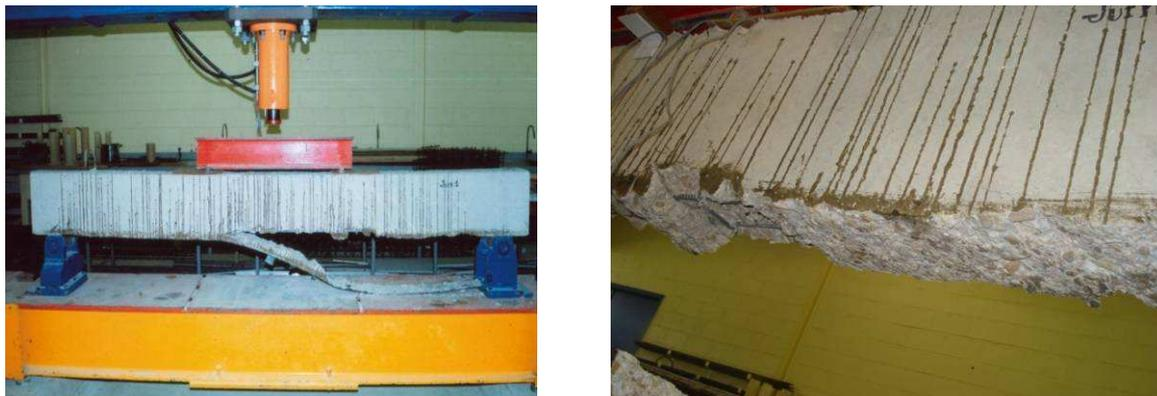
Poutre renforcée de 5 couches CFRP- série « B »
