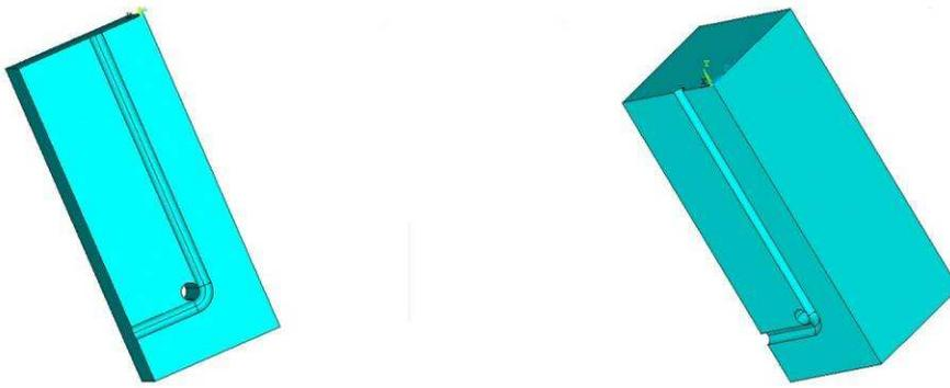
*Fig.4.11. : Des volumes créés pour le béton avec des réservations pour les volumes de l'armature longitudinale et pour les cadres.*
