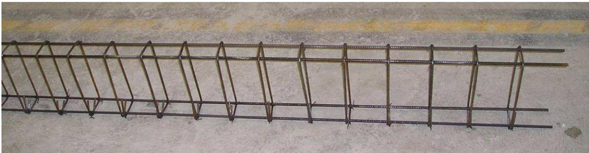
Fig.3.2. : Ferrailage des poutres série A.
