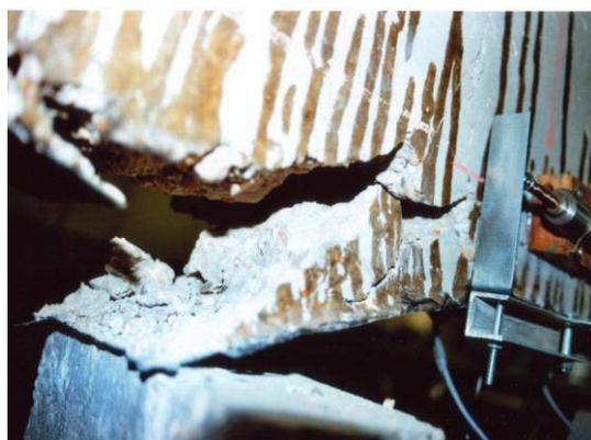
Poutre renforcée de 3 couches CFRP- série « B »
