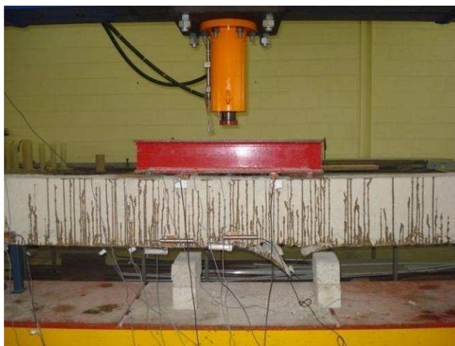
*a) Rupture dans l'enrobage en béton accompagnée par rupture du matériau composite.*
