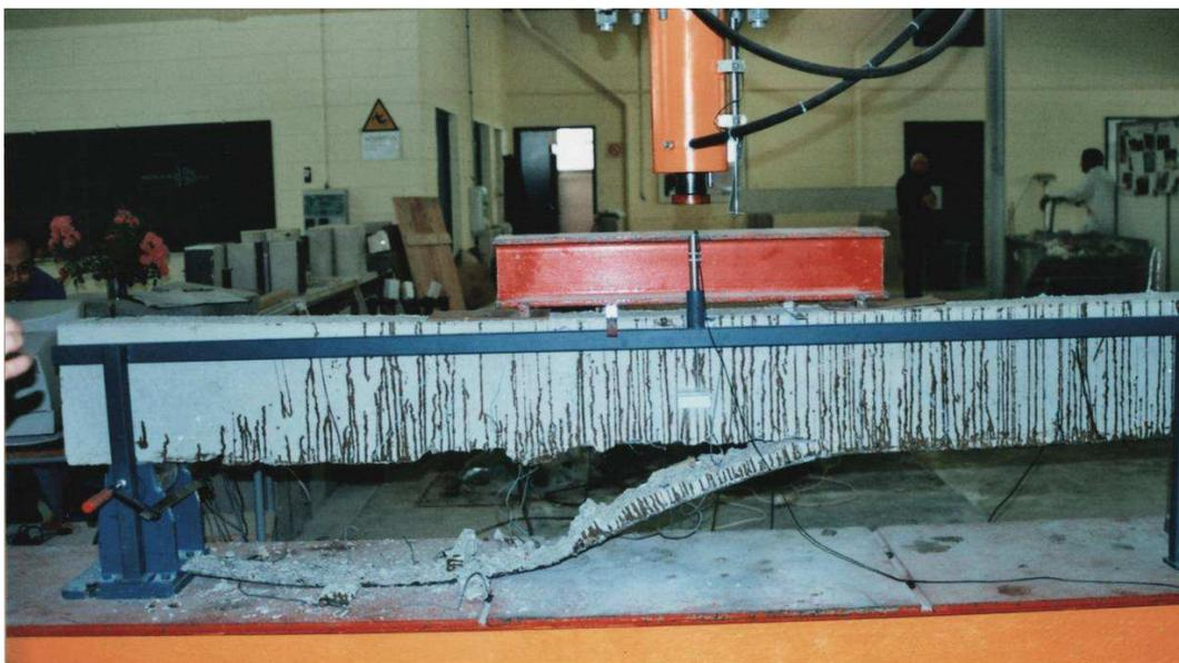
*Fig.3.17. : Dispositif de mesure de la flèche de la poutre renforcée.*
