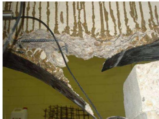
Poutre renforcée de 3 couches CFRP- série « A »
