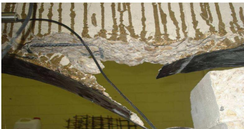
*Fig.3.25.: Rupture de la poutre renforcée par 3 couches de tissus en fibres de carbone.*
