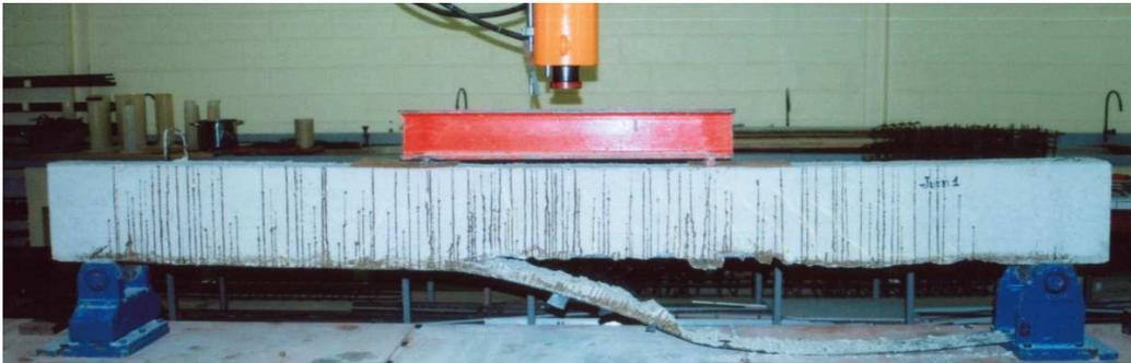
*Fig. 3.24.: Rupture de la poutre renforcée par 5 couches de matériau composite.*
