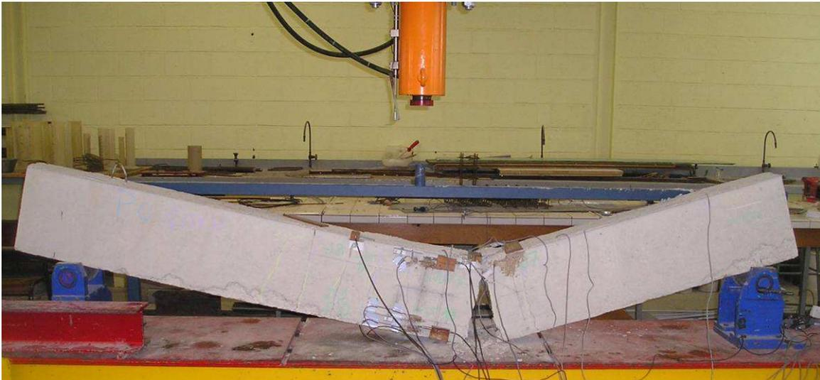
*Fig. 3.21. : Poutre de référence: Rupture due au moment fléchissant.*
