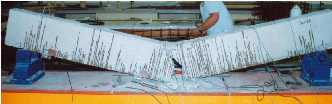
*Fig. 3.22. : Rupture de la poutre renforcée par 2 couches de matériau composite.*
