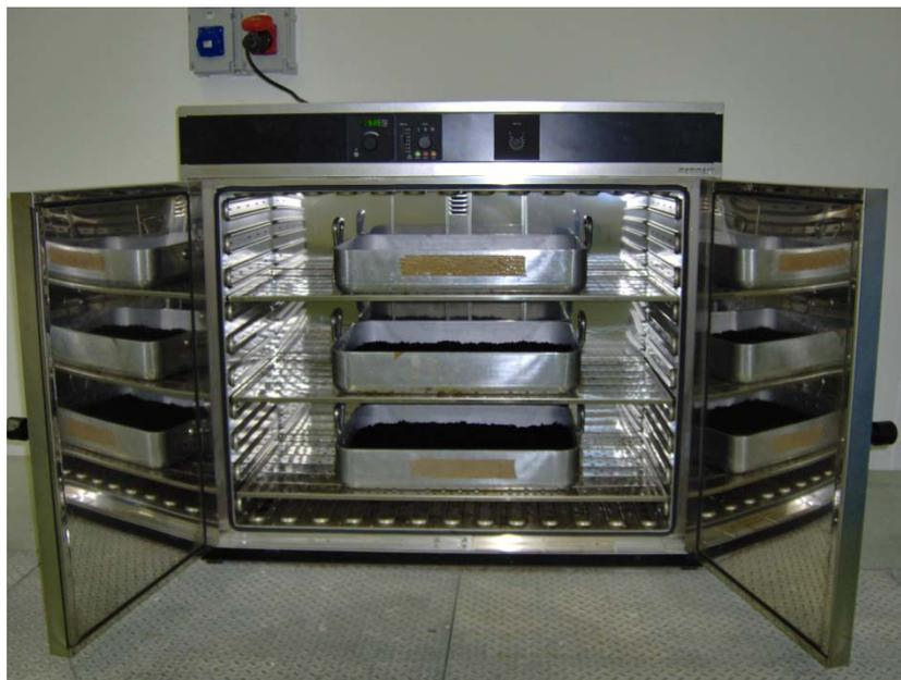
Figure 2-8 : Séchage en étuve des granulés
