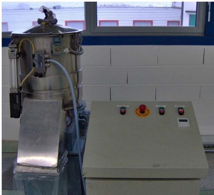
Figure 2-9 : Turbo-mélangeur
