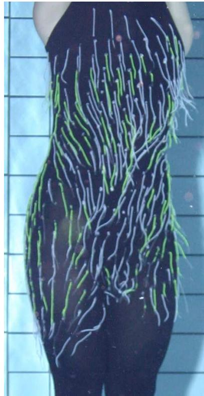
Combinaison équipée par des fils portée par une nageuse
