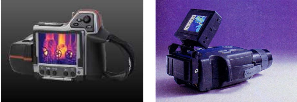
Figure V- 2 : Caméra thermique infrarouge utilisée pour mesurer les températures cutanées du nageur
