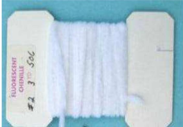
Figure IV- 20 : Fils fluorescents utilisés pour la visualisation des écoulements
