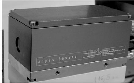
FIG. 2.8 – Photographie du boîtier laser LLH
