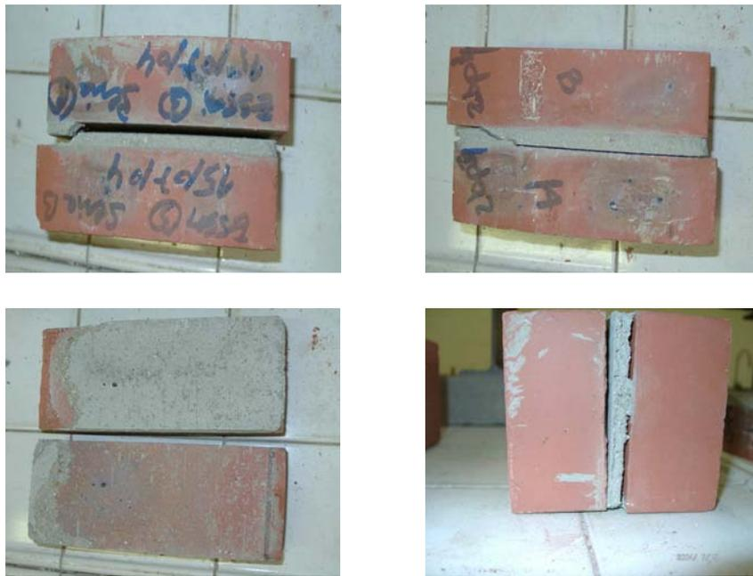
FIG. 2.29 – Essai de cisaillement sur le couplet en briques pleines N3
