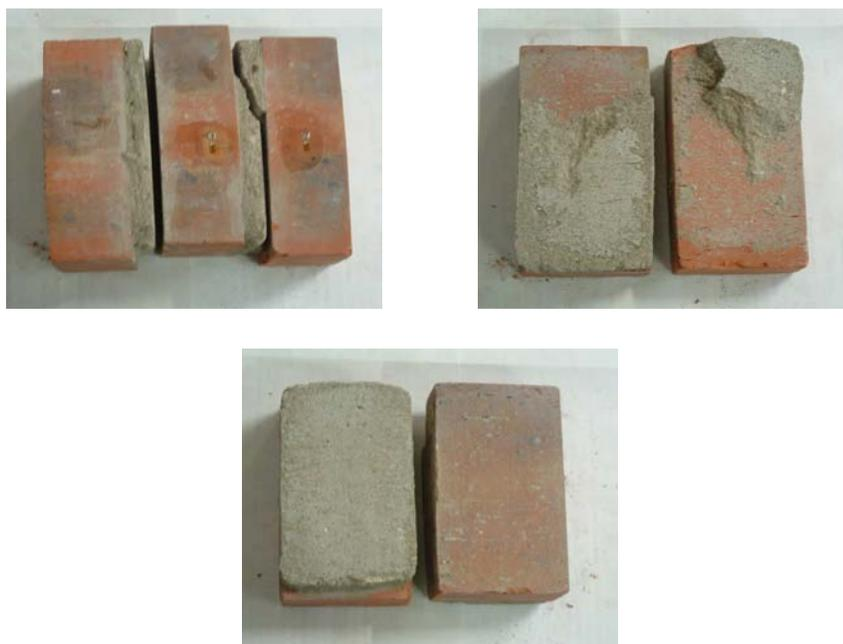
FIG. 2.39 – *Essai de cisaillement sur le triplet en briques pleines N3*
