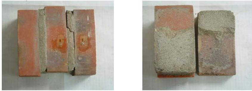
FIG. 2.40 – Essai de cisaillement sur le triplet en briques pleines N4
