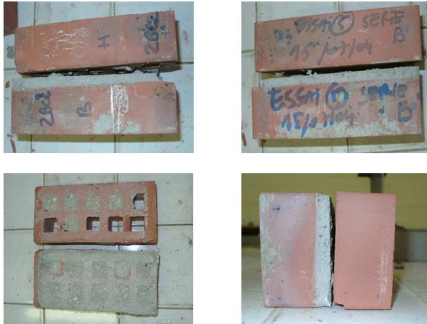
FIG. 2.33 – Essai de cisaillement sur le couplet en briques creuses N2
