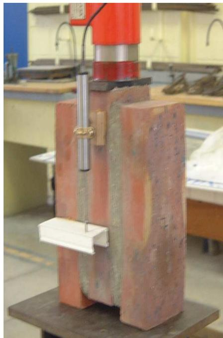
FIG. 2.35 – Essai de cisaillement sur un assemblage de triplet en briques pleines
