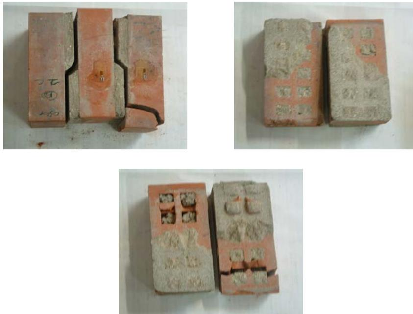
FIG. 2.43 – Essai de cisaillement sur le triplet en briques creuses N1
