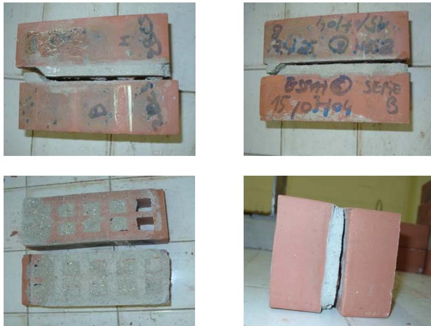
FIG. 2.34 – Essai de cisaillement sur le couplet en briques creuses N3
