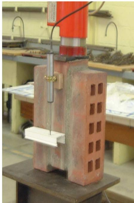
FIG. 2.41 – Essai de cisaillement sur un assemblage de couplets en briques creuses
