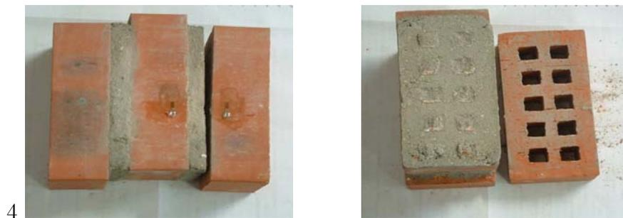
FIG. 2.46 – Essai de cisaillement sur le triplet en briques creuses N4
