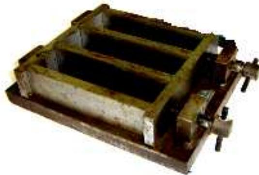
FIG. 2.1 – Moule à trois alvéoles pour éprouvettes  $4 \times 4 \times 16$
