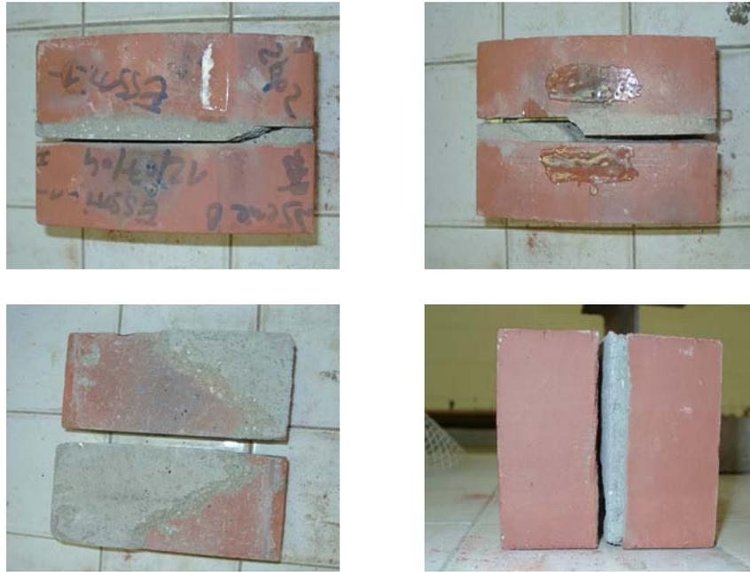
FIG. 2.27 – Essai de cisaillement sur le couplet en briques pleines N1
