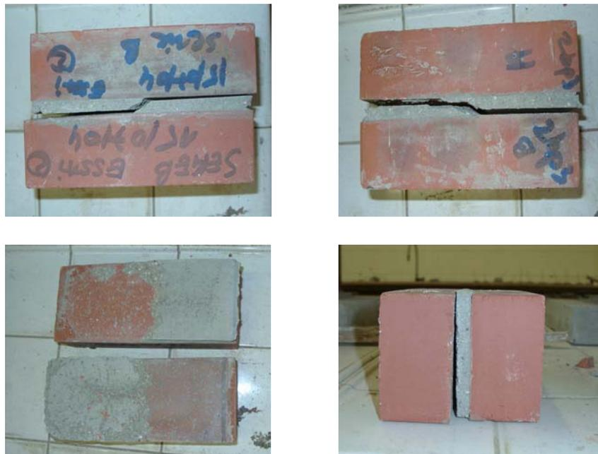
FIG. 2.28 – Essai de cisaillement sur le couplet en briques pleines N2
