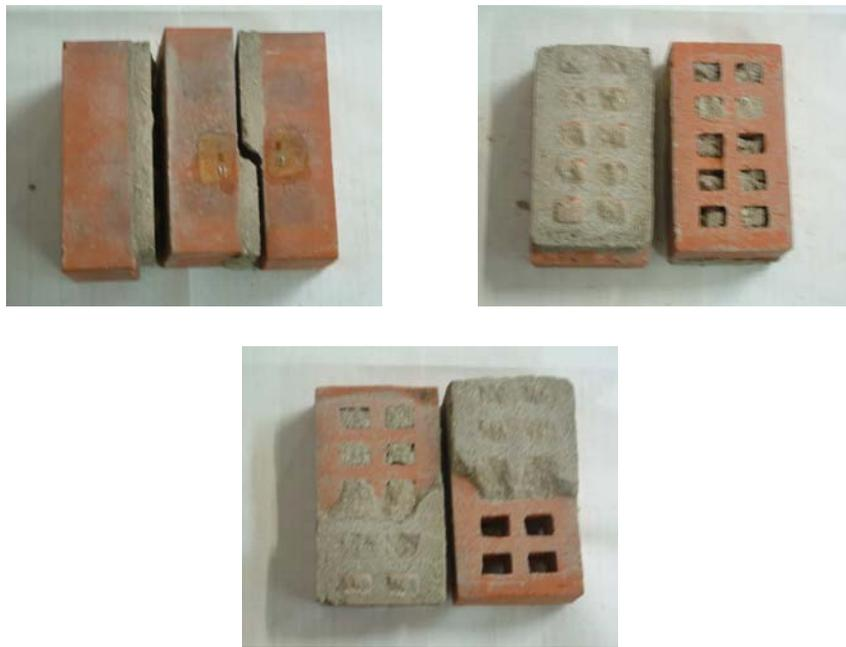
FIG. 2.44 – Essai de cisaillement sur le triplet en briques creuses N2
