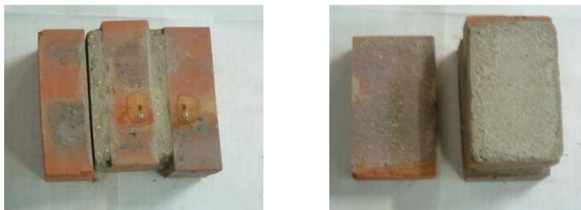
FIG. 2.38 – *Essai de cisaillement sur le triplet en briques pleines N2*
