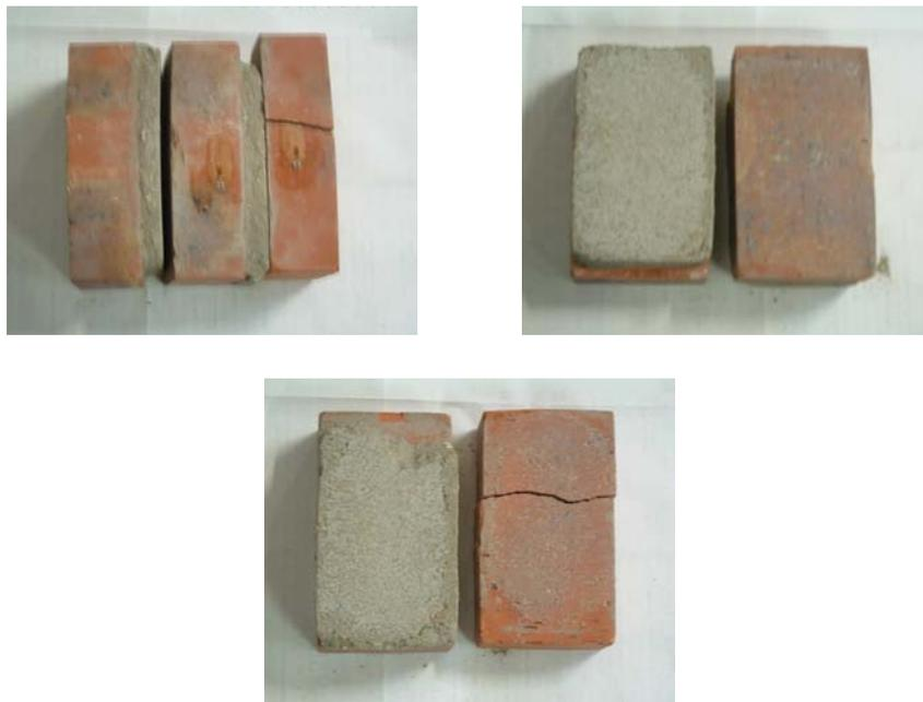
FIG. 2.37 – Essai de cisaillement sur le triplet en briques pleines N1
