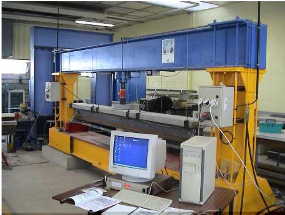
FIG. 2.7 – Machine de chargement en compression et chaîne d'acquisition de données
