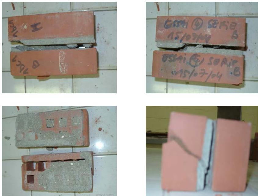
FIG. 2.32 – Essai de cisaillement sur le couplet en briques creuses N1
