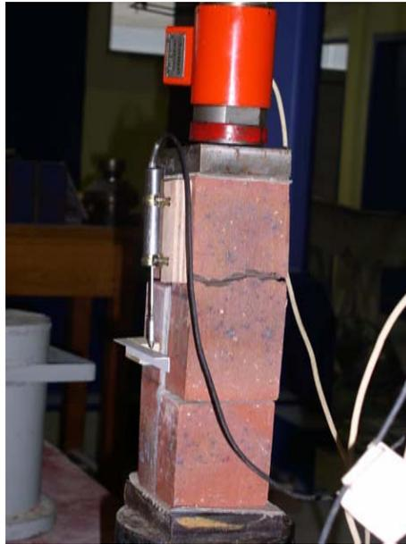
FIG. 2.24 – Essai de cisaillement N3 : Modes de rupture
