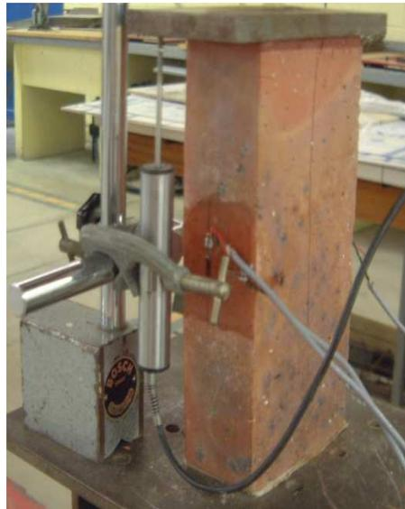
FIG. 2.5 – *Essai de compression : Disposition du capteur de déplacements*
