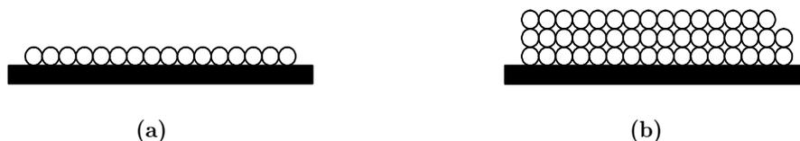
Figure 1.2: Arrangement des couches d'adsorbat : (a) en monocouche, (b) en multicouche[4].
