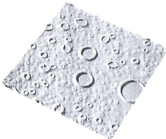
Figure 5.7: Image AFM d'une couche mince de porphyrine obtenue par deep-coating.
