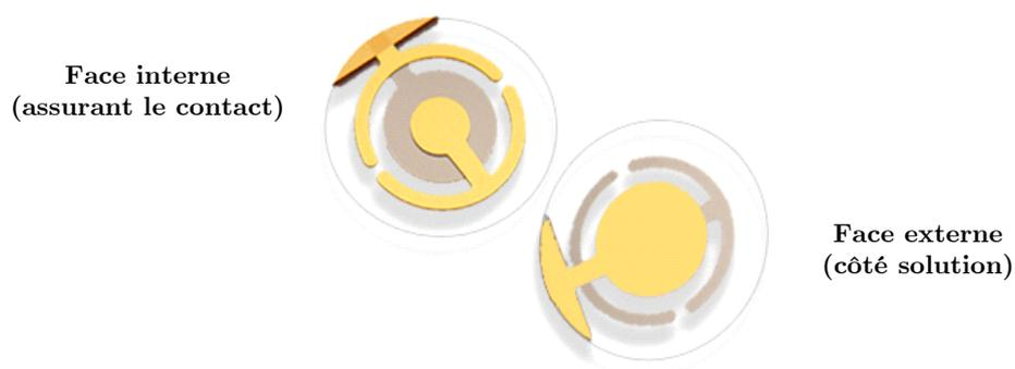
Figure 5.4: Schéma du disque de quartz utilisé au cours de l'expérience[81].
