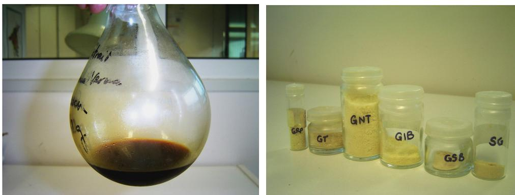
**Figure 92 : photo de l'extrait brut de cresson prêt à être injecté en CPC ; photo de quelques GSLs récupérés des expériences d'EIFCPC : de la gauche vers la droite - glucoraphanine (GRP), glucotropaeoline (GT), gluconasturtiine (GNT), glucoibervérine (GIB), sinalbine (SB) et sinigrine (SG).**
