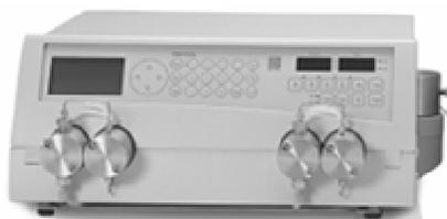
*Figure 17 : pompe binaire P580HPG Dionex® utilisée au laboratoire.*
