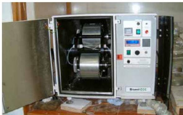
**Figure 8 : photo d'un appareil de HSCCC à double bobine, de type J [44].**
