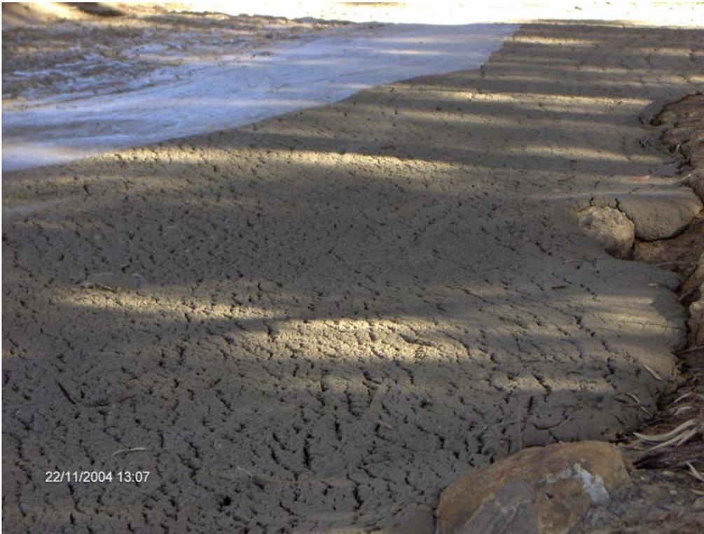
Photo N°1: Ecoulement de la vase à sa sortie d'une vidange de fond.
