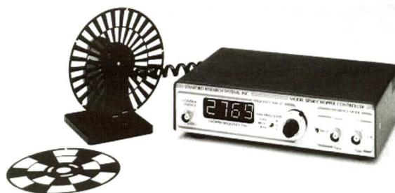
**Figure IV.29** : Modulateur opto-mécanique et ses disques crénelés (modèle SR 540)
