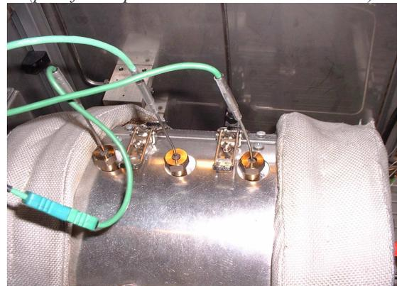
**Figure IV.15** : Montage «type baïonnette» des thermocouples
