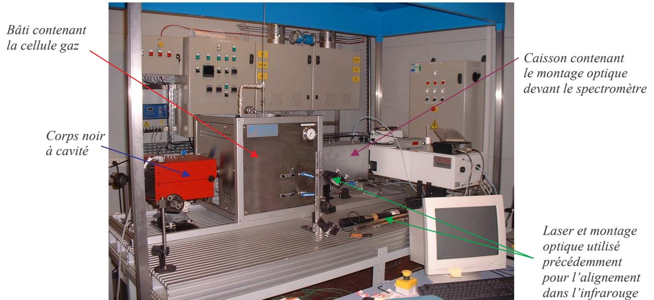
**Figure IV.32** : Montage pour la calibration du spectromètre
