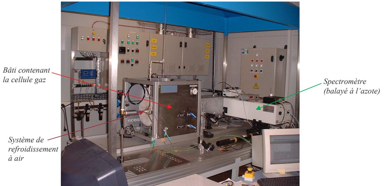
**Figure IV.110** : Ensemble du banc expérimental dans la configuration *paroi opaque-hublot*
