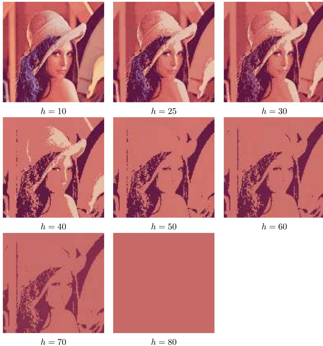
FIG. 4.3 – Segmentation de l'image "Lena" à l'aide de l'algorithme du Mean-Shift avec différents paramètres de lissage. Les couleurs des classes (régions) sont les couleurs moyennes des pixels composant ces classes.
