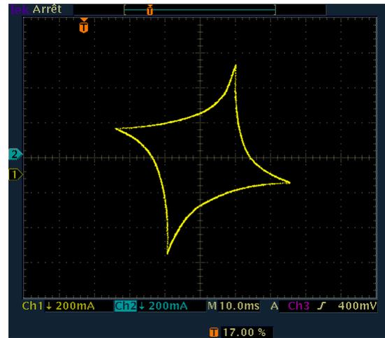
Trajectoire dans le plan  $I_\alpha, I_\beta$ Figure 53 : Mode de fonctionnement périodique  $f_c=40\text{Hz}$
