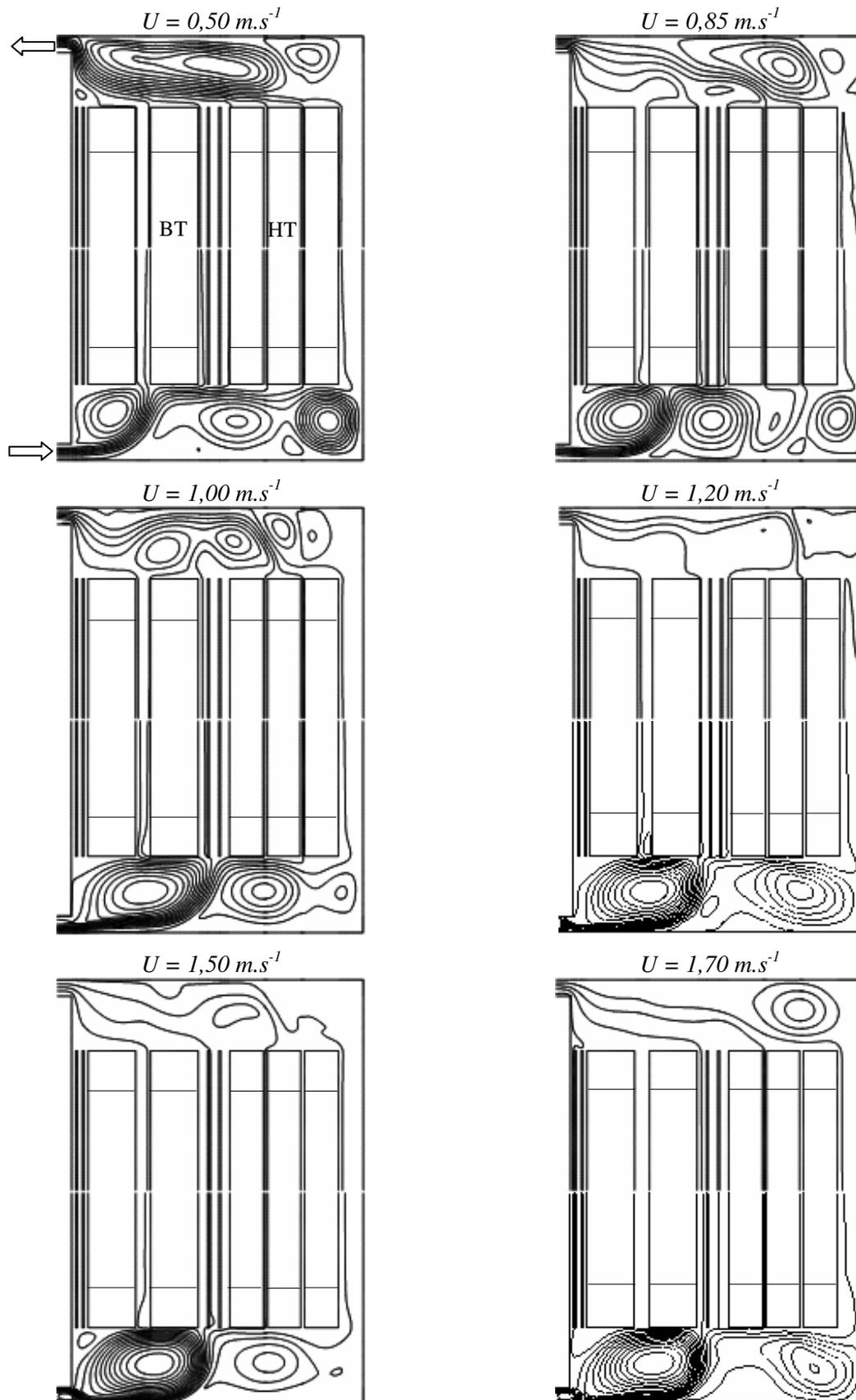
Figure III.47 : Lignes de courant dans la partie supérieure et inférieure du transformateur pour différentes vitesses imposées à l'entrée du transformateur dans le cas 8
