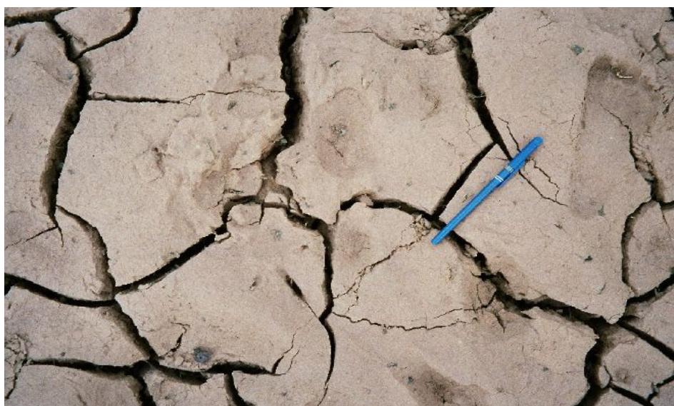
Photo n°12 : Fentes de dessica- tion sur matériau argileux en saison sèche (Hauchart, 2004)
