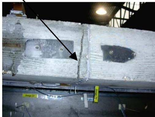
Photo V.5- Fissure de la dalle du milieu
