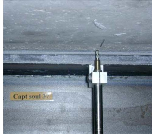
**Photo 2.** Mesure de soulèvement, P7
