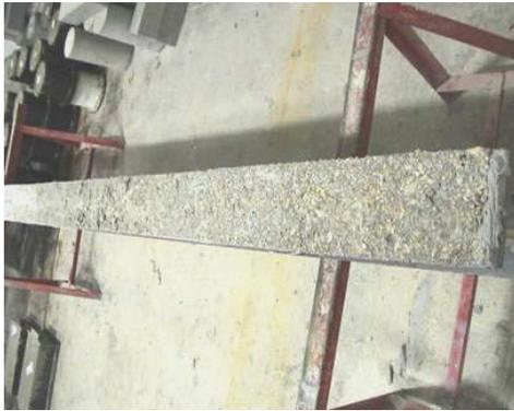
Photo IV.6- Couche de béton restant collée sur l'acier après rupture (P5)
