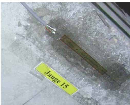
**Photo 5.** Jauge pour mesurer les déformations du béton, P7
