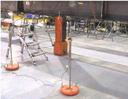
**Photo 3.** Capteur pour mesurer la flèche au milieu de la poutre, P7
