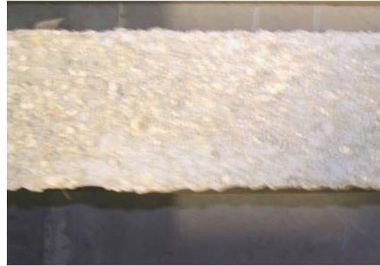
Photo IV.7- Couche de béton restant collée sur l'acier après rupture (P6)
