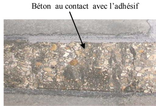
b)- Rupture à l'interface colle-béton
