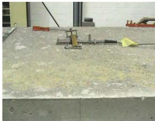
**Photo 4.** Extensomètre pour mesurer les déformations sur le béton, P7
