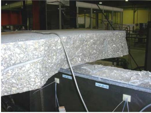
Photo V.3- Séparation entre la dalle de l'extrémité et celle d'avant (coté Nord)
