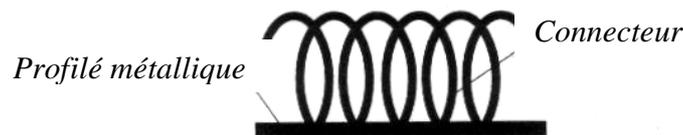
Figure II.1- Connecteur, en forme d'hélice, soudé au profilé en acier
