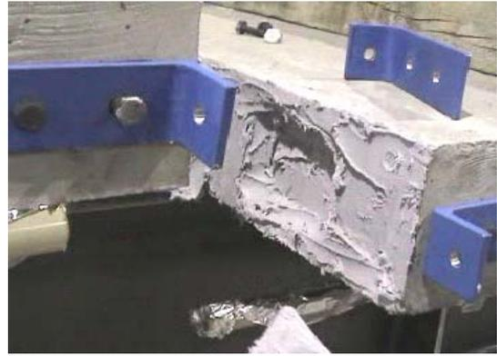
**Photo 7.** Embouts male/femelle pour alignement des dalles de la poutre P7
