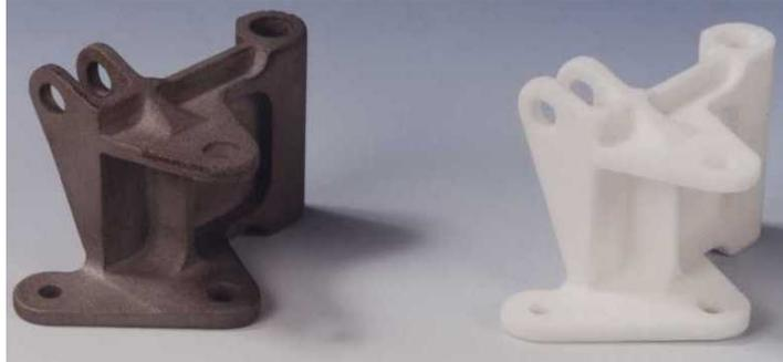
**Figure 1.5.** Pièces réalisées en frittage de poudre
