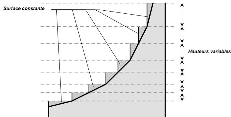
Figure 2.17. Variation des hauteurs lors d'une stratification avec une surface d'erreur constante
