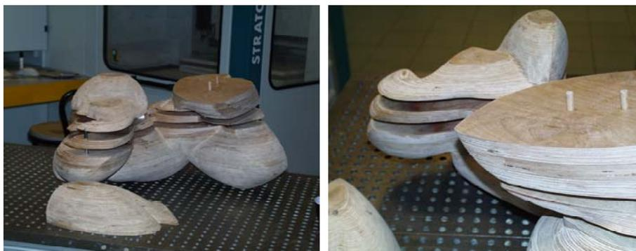
**Figure 1.21.** Assemblage des strates de *Océane*
