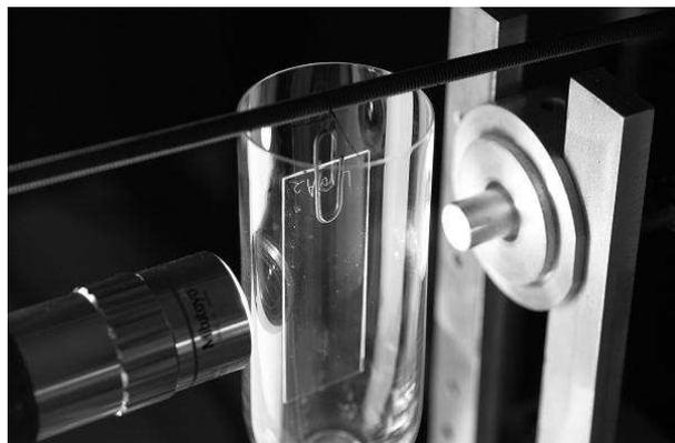
FIG. 7.12 – Montage réalisé pour observer la nucléation de profil. Une lame de microscope (ou parfois une lamelle) est suspendue à un fil. Le fil est nécessaire pour désolidariser au maximum le trombone de la tige filetée, ce qui permet à la gravitation d'assurer la verticalité de la lame.
