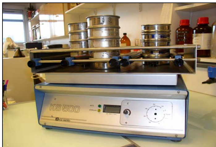
Photo 9 : L'agitateur-secoueur aide au tamisage des échantillons et au passage complet de la solution de réhydratation au travers de la colonne de tamis.
