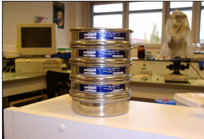
Photo 8 : Tamisage des échantillons dans la colonne de tamis à maille décroissante.
