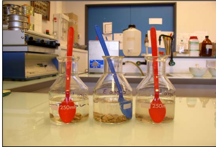
Photo 4 : Phase de réhydratation du matériel dans la solution de phosphate trisodique à 0,5 % et de glycérol à 5 %.
