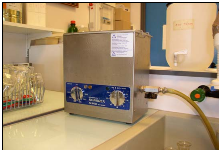
Photo 6 : La cuve à ultrasons.
