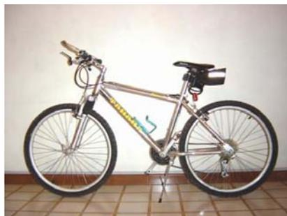
图 1-1 由框架直接构成的结构(自行车)
