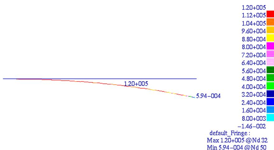
图 3-10 等强度梁的应力云纹图和变形图
