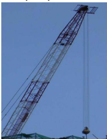
图 1-2 由框架直接构成的结构(吊车)
