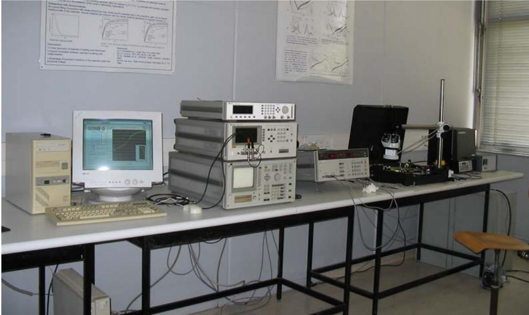
**Figure 22 :** Banc de caractérisation de capacités et de transistors MOS
