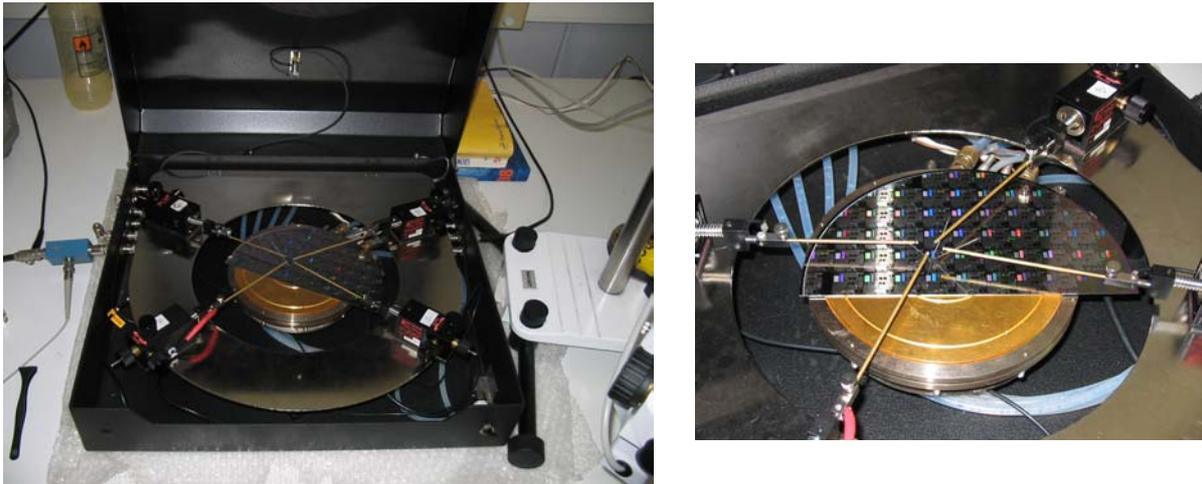
Figure 24 : Boite de mesure pour wafer sous pointe
